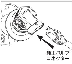
純正バルブコネクターとLEDバルブを接続してください。バッテリーのマイナス端子を接続し、ライトのスイッチをONにして点灯確認をしてください。
