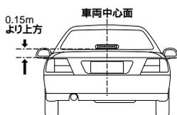
ランプの中心が車幅の中心面の位置で、リアガラス最下端の下方0.15mより上方に取り付け。
