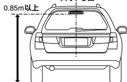
ランプの中心が車幅の中心面の位置で、ランプ下縁が地上より0.85m以上の高さに取り付け。
